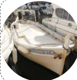
Le pointu fait partie du patrimoine marseillais. Il doit son nom à la forme de ses extrémités, forme qui lui permet de couper la vague et d'être stable même en cas de mauvaise mer.
